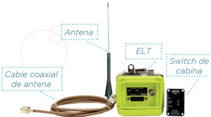
Esquema básico de ubicación de componentes de un ELT en aeronave de aviación general
